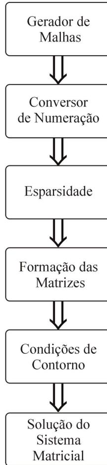
*Fig. 3.5 – Fluxograma do método da envoltória utilizando as funções de base de arestas ortogonais.*
