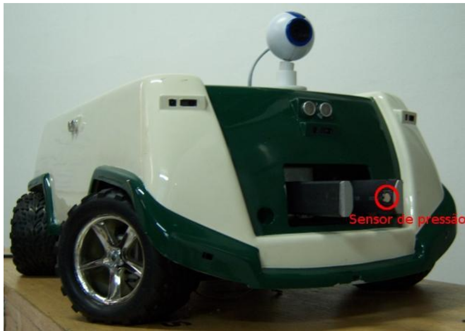
Figura 93: Robô Universal com módulo da garra, detalhe para o sensor de pressão [01].
