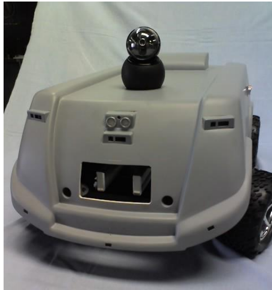
Figura 21: Instalação da Webcam com PTZ
