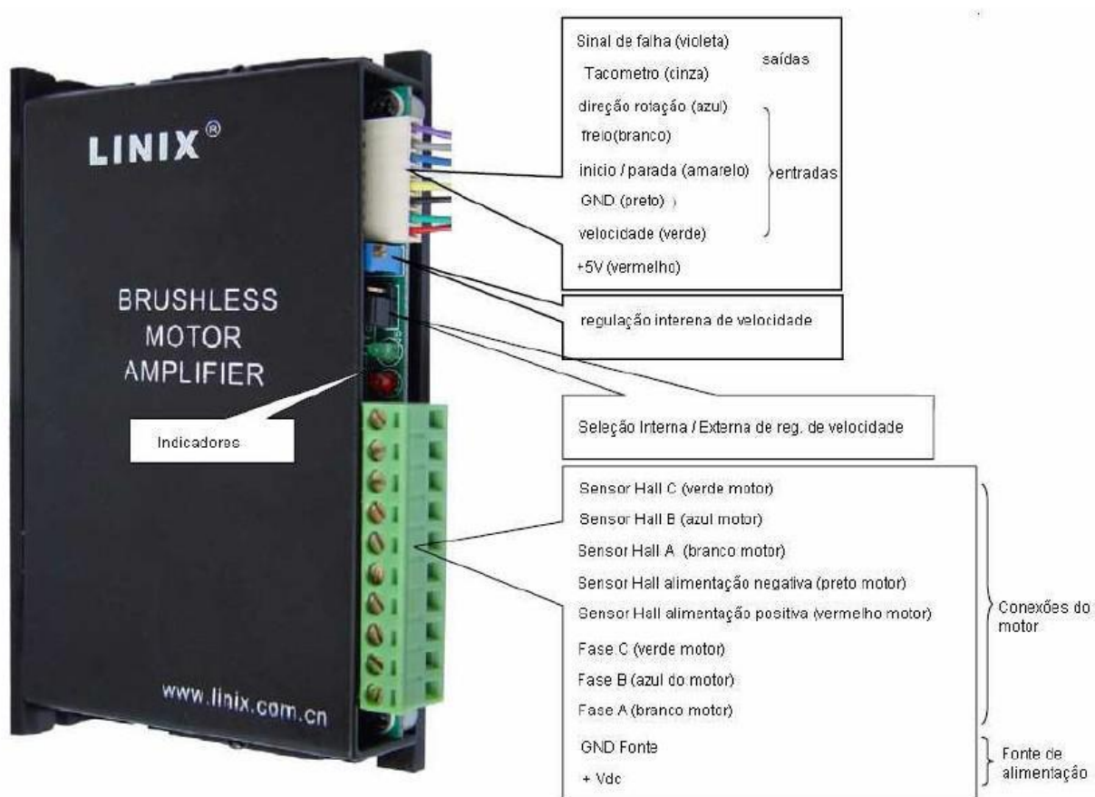
Figura 124: Foto do Driver indicando suas entradas
