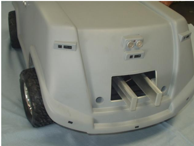
Figura 107: Robô mostrando a posição da pinça mecânica [01].
