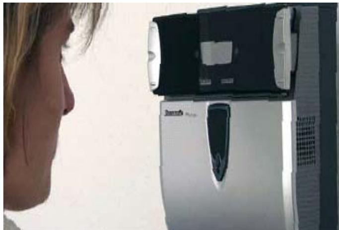
Fig. B.1 Dispositivo comercial de captura de uma imagem de íris [37].
