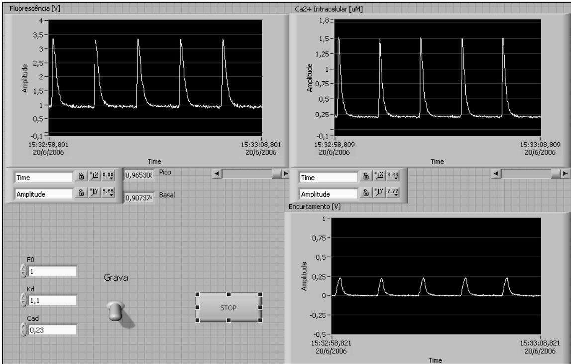
Figura 3.8: Interface gráfica desenvolvida em LABVIEW 7.1<sup>®</sup> para visualização e controle da aquisição dos sinais.
