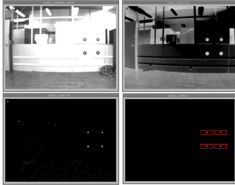
Figura 3.4 – Alguns dos passos utilizados para a segmentação dos centróides.
