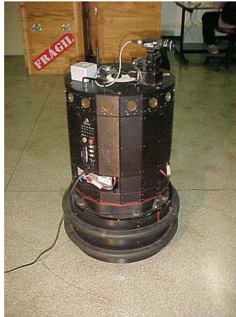
Figura 3.3 – Robô móvel terrestre Nomad 200.
