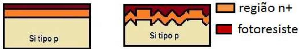
Figura 42: Série 2- Lâminas série 2 com aplicação de fotoreviste AZ 5214 após o pré-bake de 90° C por 4 minutos.
