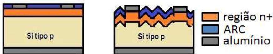
Figura 46: Série 2- Estruturas das células fotovoltaicas da série 2 terminadas.
