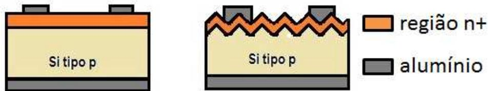
Figura 31: Série 1- Lâminas com os contatos elétricos depositados, 250 nm de alumínio nos contatos dianteiros e 500 nm nos contatos traseiros.
