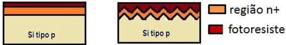
Figura 29: Série 1- Lâminas com aplicação de fotoresiste AZ 5214 após o pré-bake de 90° C por 4 minutos
