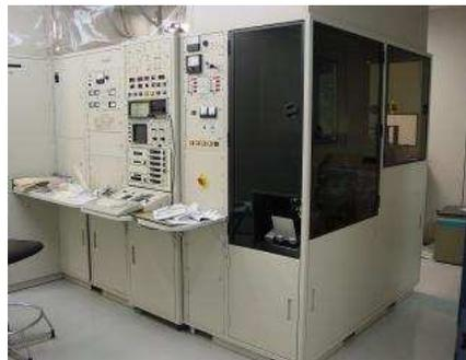
Figura 26: Implantador de Íons EATON GA4204 do Centro de Componentes Semicondutores (CCS-Unicamp)
