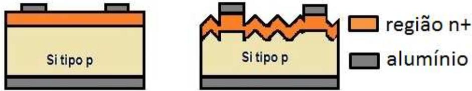
Figura 45: Série 2- Lâminas da série com os contatos elétricos depositados, 250 nm de alumínio nos contatos dianteiros e 500 nm nos contatos traseiros.
