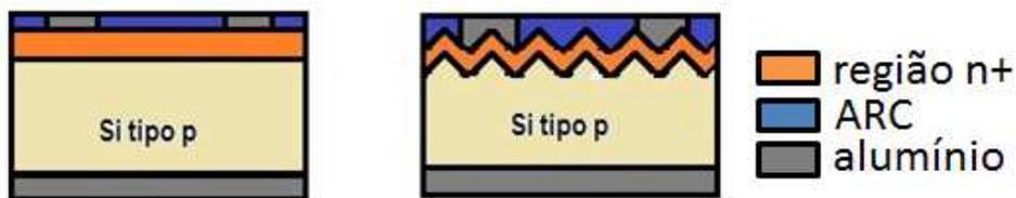
Figura 32: Série 1- Estruturas das células fotovoltaicas da série 1 terminadas.
