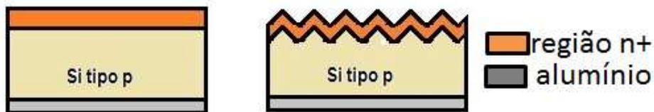
Figura 62: Série 5- Deposição de  $1\text{ }\mu\text{m}$  de alumínio para a formação de BSF.
