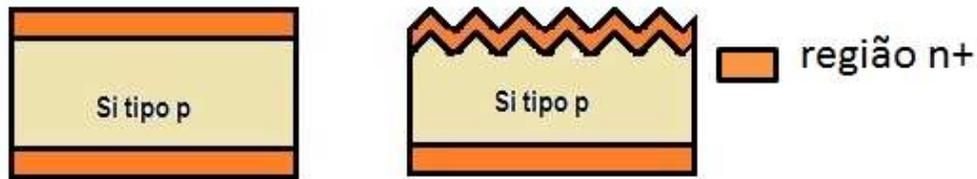
Figura 60: Série 5-Difusão de fósforo com  $\text{POCl}_3$  à temperatura de  $950\text{ }^\circ\text{C}$ , durante 20 minutos.
