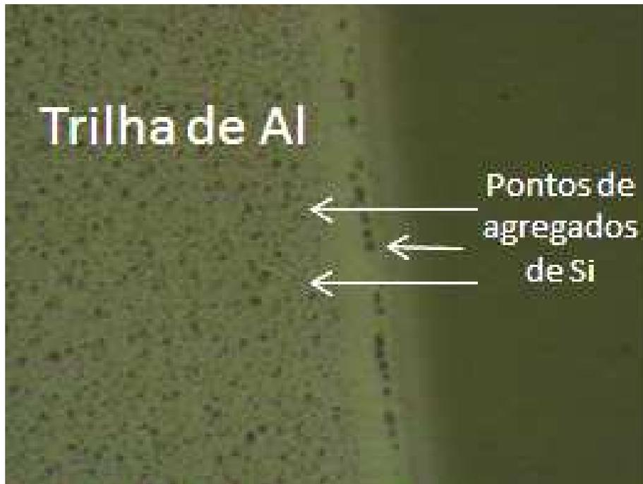
Figura 73: Eletrodos de alumínio da série 3 com pontos de agregados de Si dentro da camada metálica.
