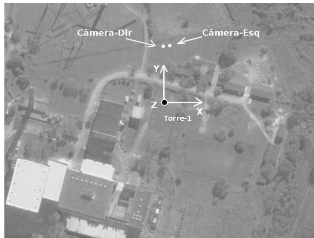
Figura 7.12: Referencial global e posicionamento aproximado do par de câmeras na planta do CEPEL. O eixo OZ sai do plano da figura.
