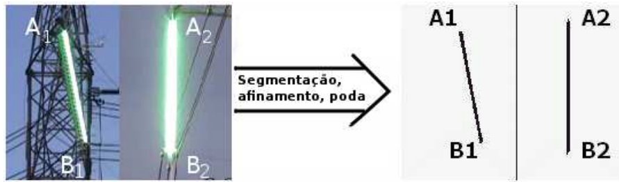
Figura 4.17: Na figura à esquerda é mostrado um par de imagens de arcos elétricos. Na figura à direita tem-se a segmentação destes arcos. (A_1, B_1) e (A_2, B_2) são pares de homólogos.
