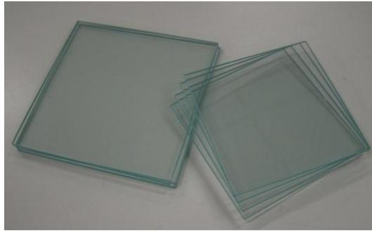
Figura 33 - Lâminas de vidro utilizadas como substrato.
