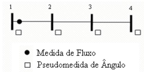
**Figura 4.6** – Sistema de Teste de 4 Barras Radial.
