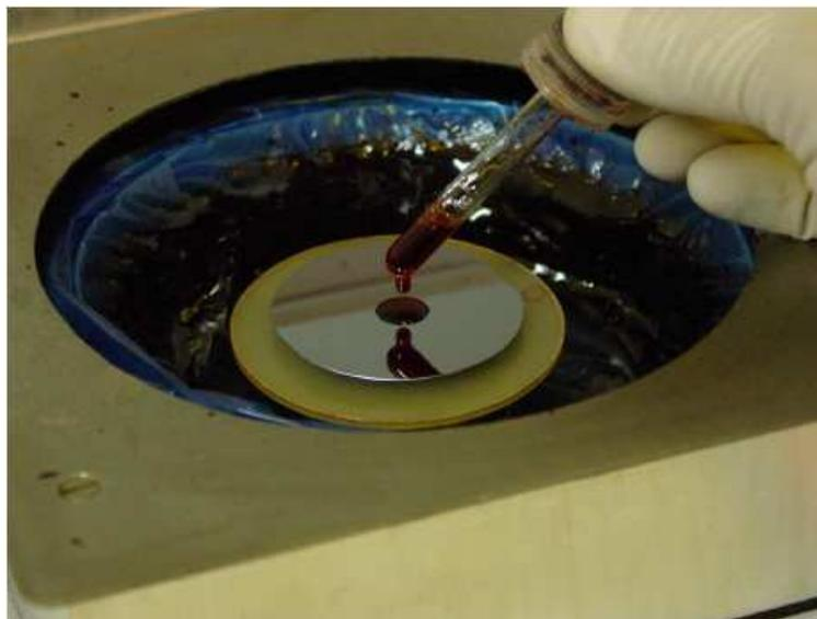
**Figura 86 – Fotografia do processo de aplicação e espalhamento do fotoresiste em uma centrífuga (Jacobus W. Swart, 2008).**
