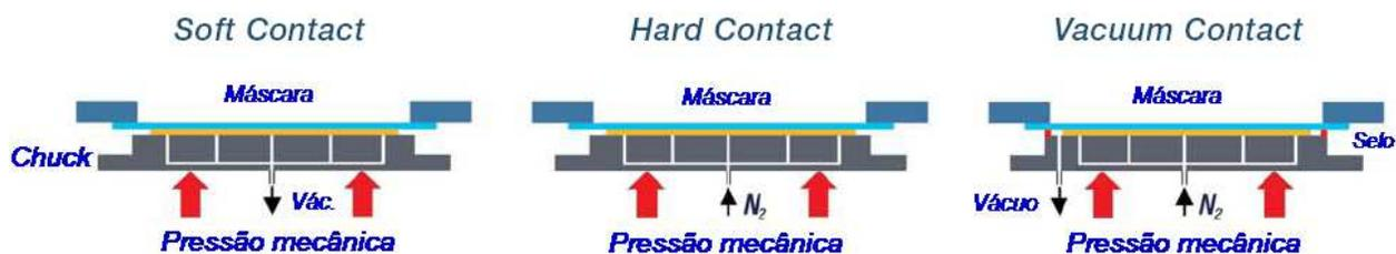
Figura 87 – Modos de operação da fotoalinhadora SUSS MicroTec MJB 4. Modificado de Manual mask aligner SUSS MicroTec MJB 4.
