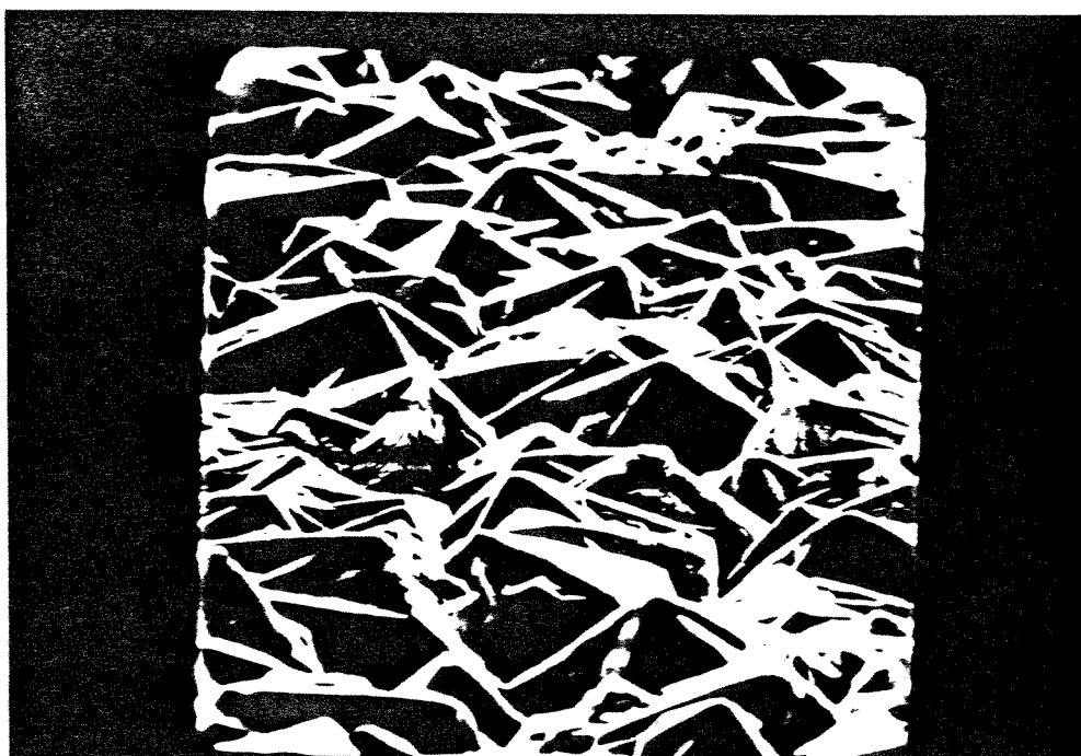
Figura 4.20: Fotografia SEM do filme de diamante crescido a 100 Torr de pressão no reator, fluxo de hidrogênio de 170 \text{ cm}^3/\text{min} e tempo de crescimento de 20 horas. Este filme é autosustentado. O aumento da fotografia é de 1800 vezes.
