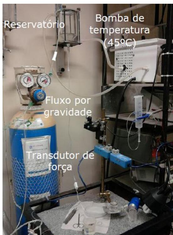
Figura 3.7: Bancada de experimentos: reservatório da solução, bomba de circulação e aquecimento de água e transdutor de força.
