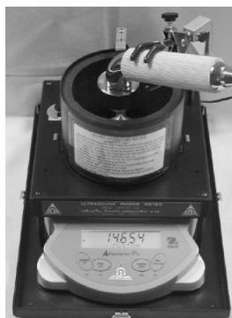
Figura 3.4: Balança digital de força de radiação
