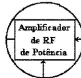
O amplificador de potência desenvolvido é um amplificador transistorizado classe AB, sendo suficiente apenas um diodo de pré-polarização para eliminar distorção de cruzamento (*cross-over*). O circuito consiste também de um amplificador classe A para produzir o ganho de tensão adequado (aproximadamente 17 dB), visto que o classe AB só confere ganho de corrente ao sinal (BOYLESTAD,
