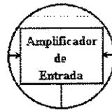
Este estágio é responsável pela amplificação inicial do sinal de eco recebido, podendo amplificá-lo em tensão em até 25 dB. Esta amplificação, entretanto, é variável de acordo com o tempo que o sinal de eco leva para chegar à face do transdutor. Isso é feito com o objetivo de compensar a atenuação adicional conferida ao sinal por ele ter que atravessar uma maior extensão de tecido. Como elemento amplificador foi utilizado o circuito integrado MC1550G, fabricado pela *MOTOROLA*®.
