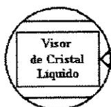
O visor de cristal líquido utilizado neste trabalho utiliza um sistema que se convencionou chamar de módulo matricial inteligente, dada a tecnologia de interfaceamento agregada a ele, consistindo de memórias diversas (*RAM* e *ROM*) além da lógica de codificação, responsável pela conversão dos dados que um sistema microprocessado qualquer fornece ao módulo em informação passível de leitura no visor.
