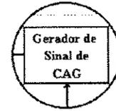
O circuito gerador de sinal de controle de ganho alimenta o amplificador de entrada com um sinal exponencial de tensão decrescente com o tempo, com 3,7 V de máximo e 3,45 V de mínimo em tensão, correspondendo a 46 dB e 71 dB de ganho total de tensão mínimo e máximo, respectivamente, para o circuito de recepção.
