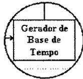
O gerador de base de tempo produz o sinal que é utilizado pelo controle para calcular a medida de espessura. São os dois primeiros ecos adjacentes, correspondentes às duas primeiras interfaces no prolongamento do eixo longitudinal do transdutor (membrana do acoplador-pele/gordura e gordura-músculo), que geram a base de tempo para a medição.
