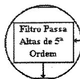
Como foi visto no item 2.5.2.3 do capítulo anterior, foi desenvolvido um filtro passa-altas de 5ª ordem para retirar a portadora exponencial dos sinais de eco que porventura chegassem ao transdutor de ultra-som (ver figura 2.36). Essa portadora é inserida pelo circuito do amplificador de entrada através do pino de controle de ganho, sendo produzida pelo circuito
