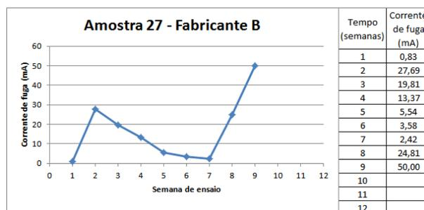
Figura 4.17 - Comportamento da corrente de fuga ao longo do ensaio de imersão na amostra retirada de campo do fabricante B.
