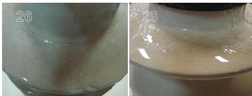
Figura 5.11 - Hidrofobicidade recuperada – amostra 26 do fabricante A e amostra 28 do fabricante C.
