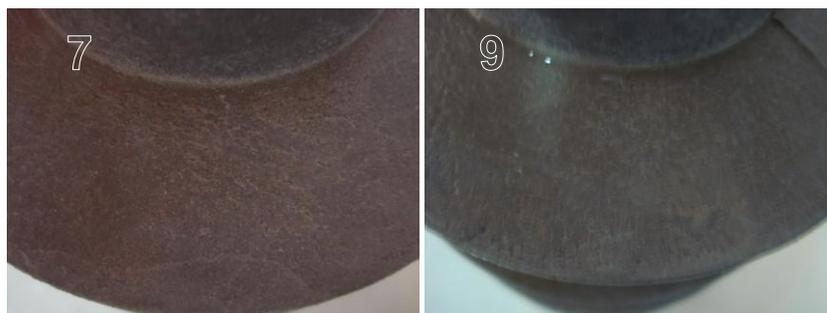
Figura 5.3 - Hidrofobicidade perdida – amostras do fabricante B.
