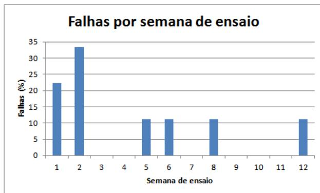
Figura 4.23 - Perfil de ocorrência de falhas ao longo do ensaio de imersão.
