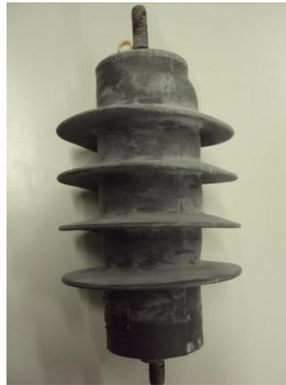
Figura 4.4 - Amostra 2 na nona medição da corrente de fuga.
