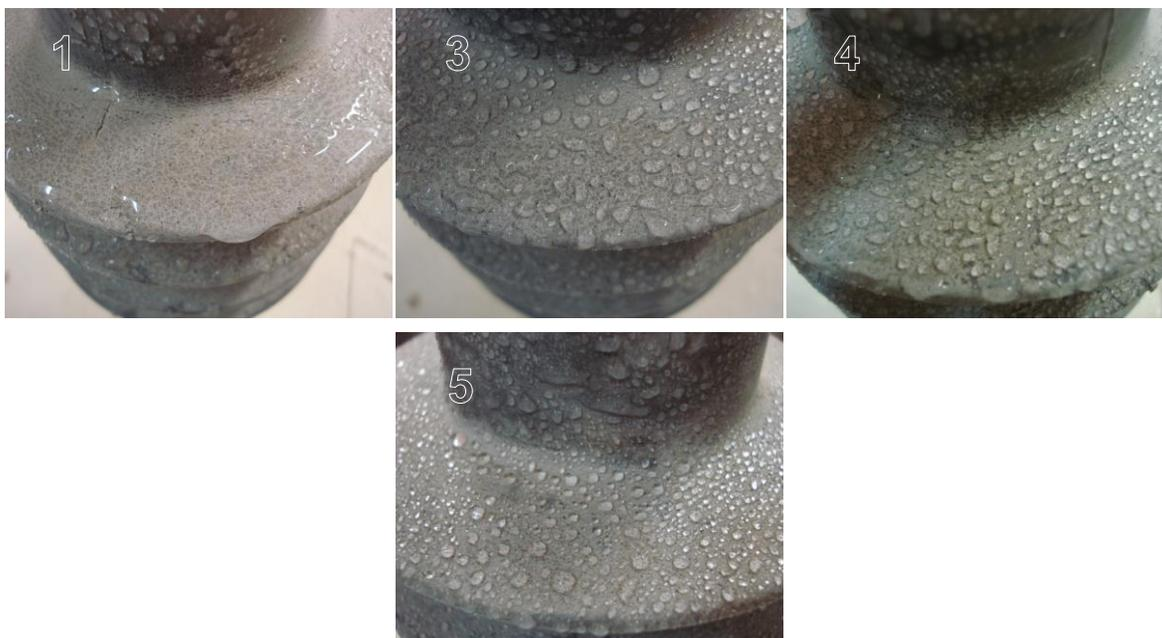
**Figura 5.7 - Hidrofobicidade recuperada – amostras do fabricante A.**
