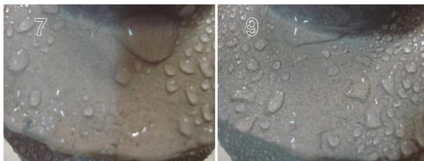
Figura 5.8 - Hidrofobicidade recuperada – amostras do fabricante B.
