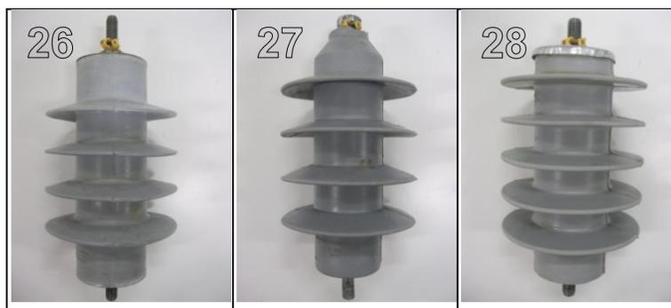
Figura A.6 - Amostras usadas - Fabricantes A, B e C.
