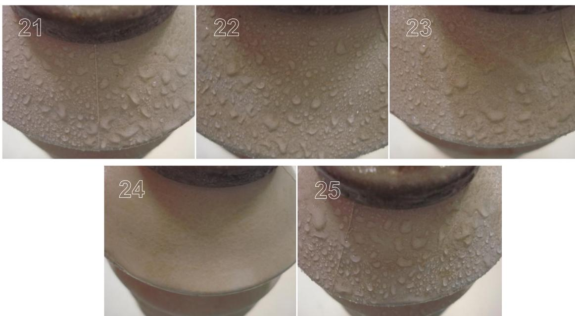
**Figura 5.5 - Hidrofobicidade perdida – amostras do fabricante E.**
