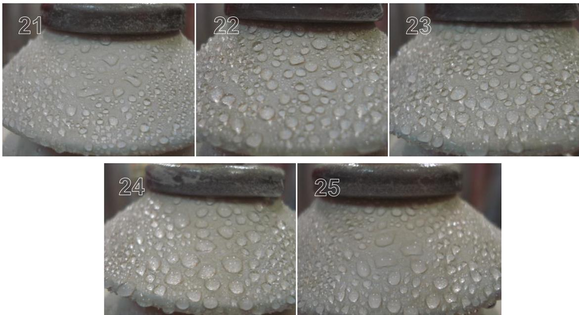
Figura 5.10 - Hidrofobicidade recuperada – amostras do fabricante E.
