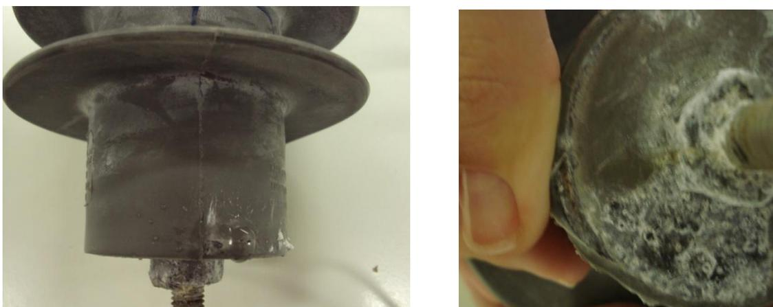
Figura 4.5 - Falha da amostra 2 pertencente ao fabricante A.
