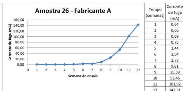
Figura 4.15 - Comportamento da corrente de fuga ao longo do ensaio de imersão na amostra retirada de campo do fabricante A.
