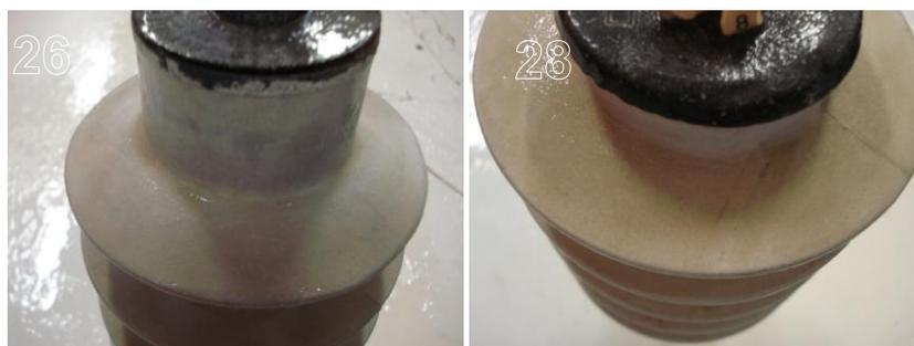
**Figura 5.6 - Hidrofobicidade perdida – amostra 26 do fabricante A e amostra 28 do fabricante C.**
