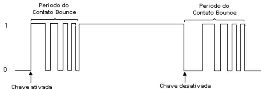
Figura 25: Sinal proveniente de uma chave exemplificando o efeito de contato “ bounce ”.
