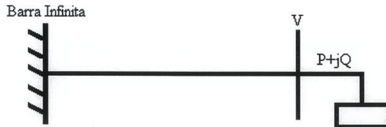
Figura 2.3 - Carga alimentada por barra infinita
