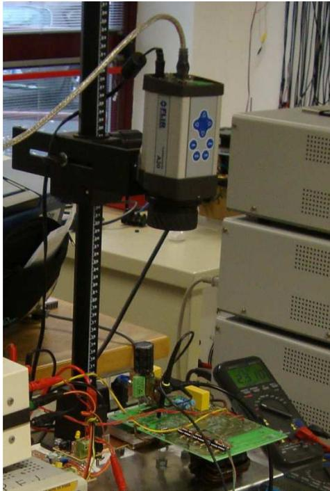
**Figura 53: Sistema de imagem térmica**
