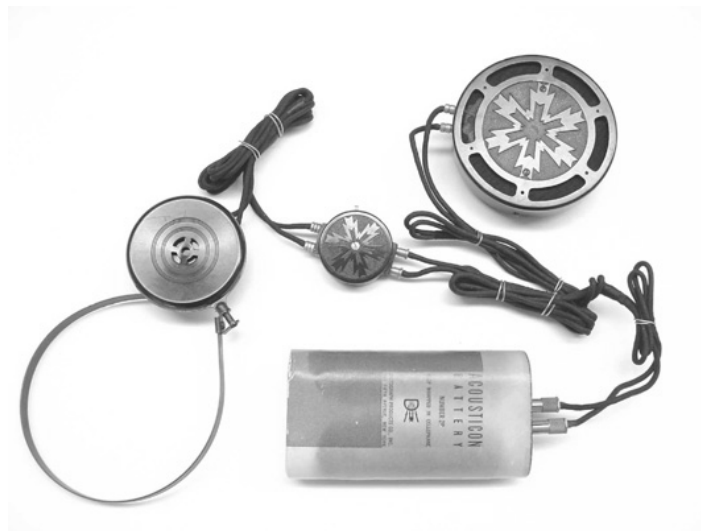
Figura 3 – Aparelho auditivo utilizando microfone de Grahman Bell [22]
