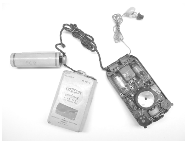
Figura 5 – Modelo de um Aparelho Auditivo ativo à válvulas eletrônicas [22]
