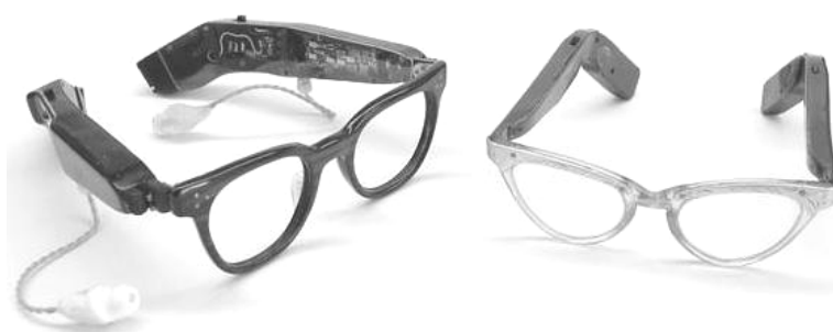
Figura 7 – Aparelho embutido na haste dos óculos, modelo Otariion Listener RX (CID-Goldstein Collection) [22]
