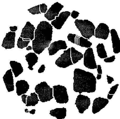
Figura 4.9: Super-segmentação obtida com a determinação direta dos watersheds utilizando a função distância euclidiana
