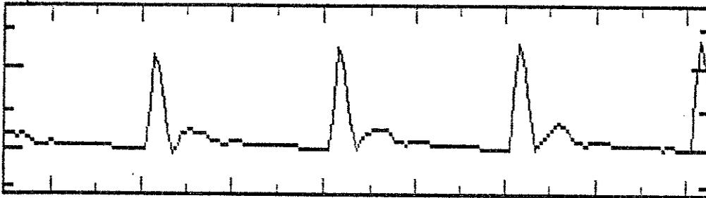
d) Sinal na Saída de um Sistema com Deconvolução Homomórfica e Análise LPC convencional - Ordem 8 e Método da Covariância
