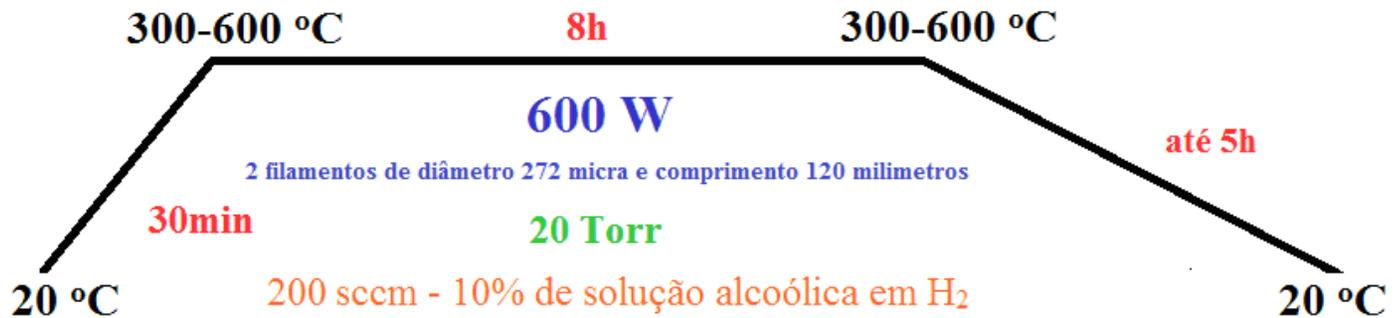
**Figura 2.12:** Representação esquemática dos parâmetros do processo de deposição de diamante microcristalino diretamente sobre substratos cilíndricos.
