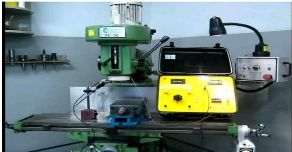
Figura 20: Medição de temperatura x rotação de uma fresa.
