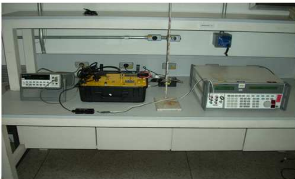
Figura 53c: SimuCal® durante a calibração do módulo da rotação.
