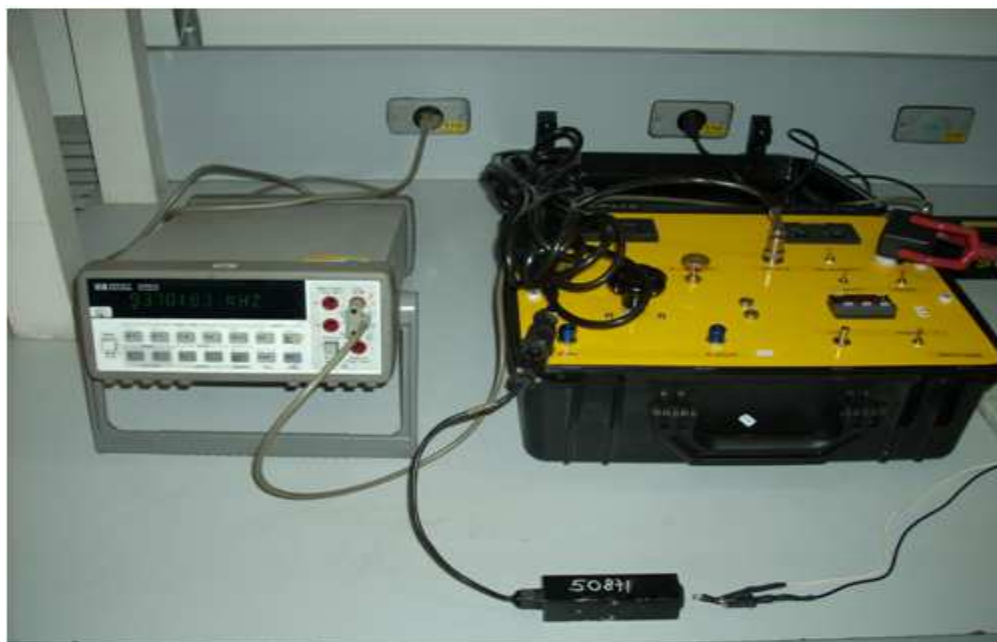
Figura 53d: Geração do sinal óptico padrão durante calibração da SimuCal®. Módulo de rotação.
