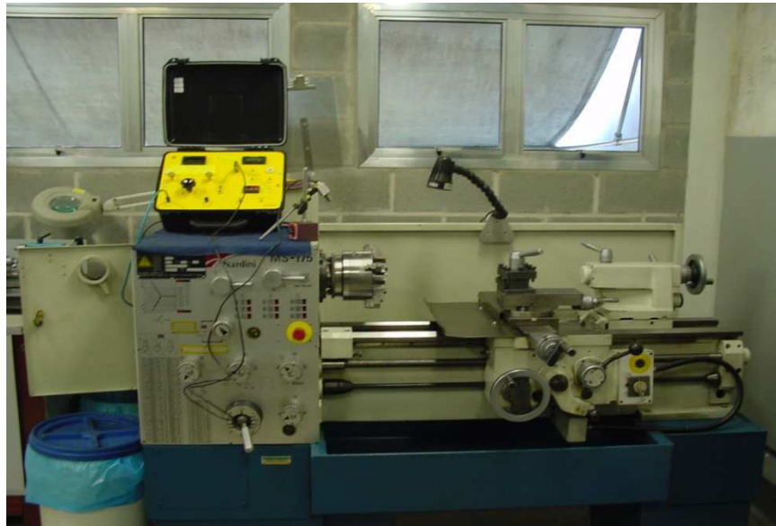
Figura 51: Trabalho em campo, medição de pressão de uma bomba de engrenagens de lubrificação forçada x rotação da máquina.
