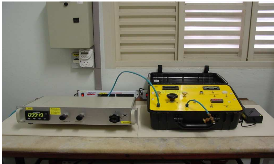
Figura 49: Calibração da maleta SIMUCAL® usando padrão RPF de pressão.
