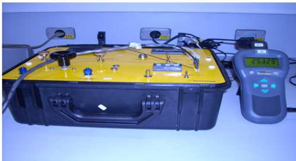
Figura 53b: Controle da temperatura ambiente na maleta SimuCal®.
