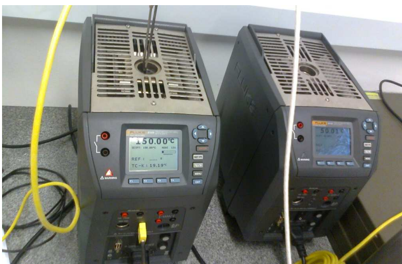
Figura 53a: Fornos padrões na calibração do módulo da temperatura.
