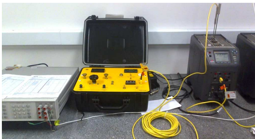
Figura 53: SimuCal® durante a calibração do módulo da temperatura.
