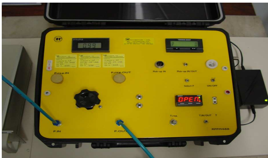
Figura 50: Aplicação da maleta SIMUCAL® durante a calibração de pressão.
