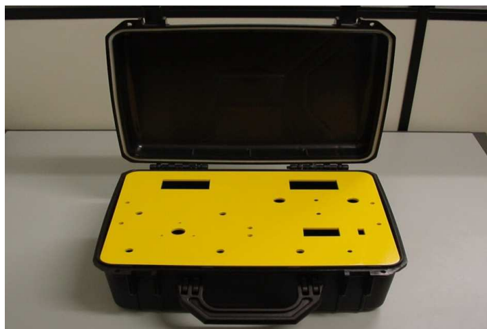
Figura 15: Case e painel já usinados, pintados e acabados.
