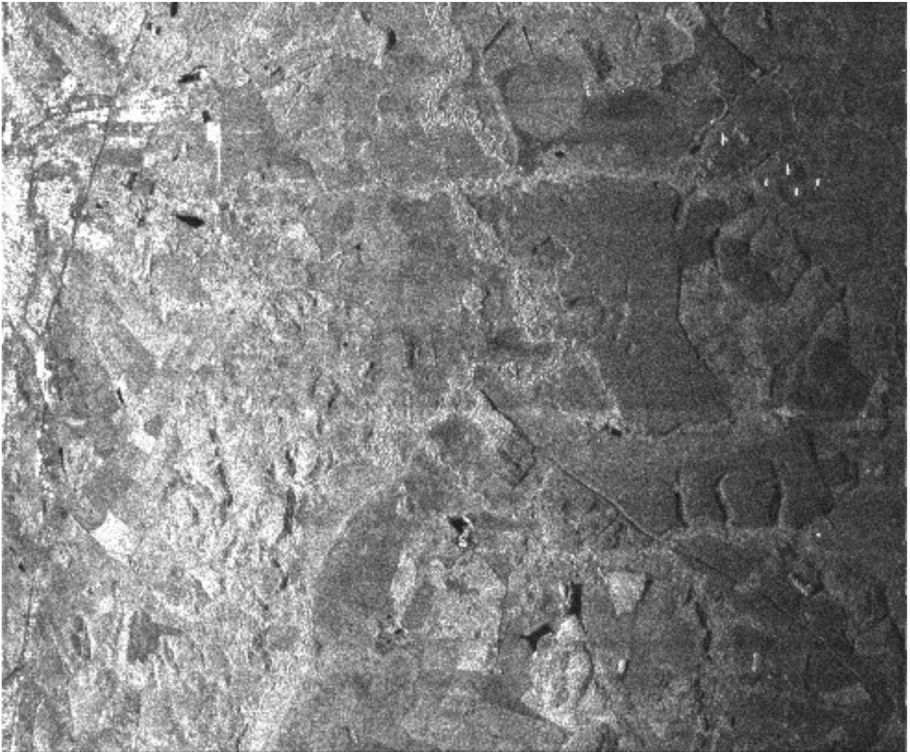
Figura 6.2: Imagem de uma área de Itapetininga, SP, Brasil. Resolução de  $10m$  em azimute x  $18,6m$  em alcance.  $22,5MHz$  de largura de faixa processada. A imagem possui  $10,6km$  em azimute por  $14km$  em alcance.
