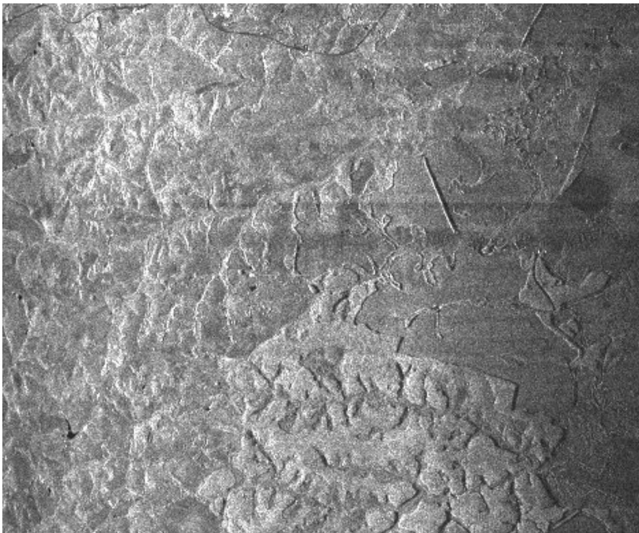
Figura 6.6: Imagem de Itapetininga-SP com resolução de  $10m$  em azimute e  $10m$  em alcance. Largura de faixa processada de  $40MHz$ . A imagem possui  $10,6km$  em azimute por  $14km$  em alcance.
