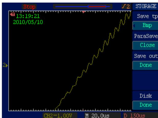
Figura 63 - Portadora sobre a tensão da rede
