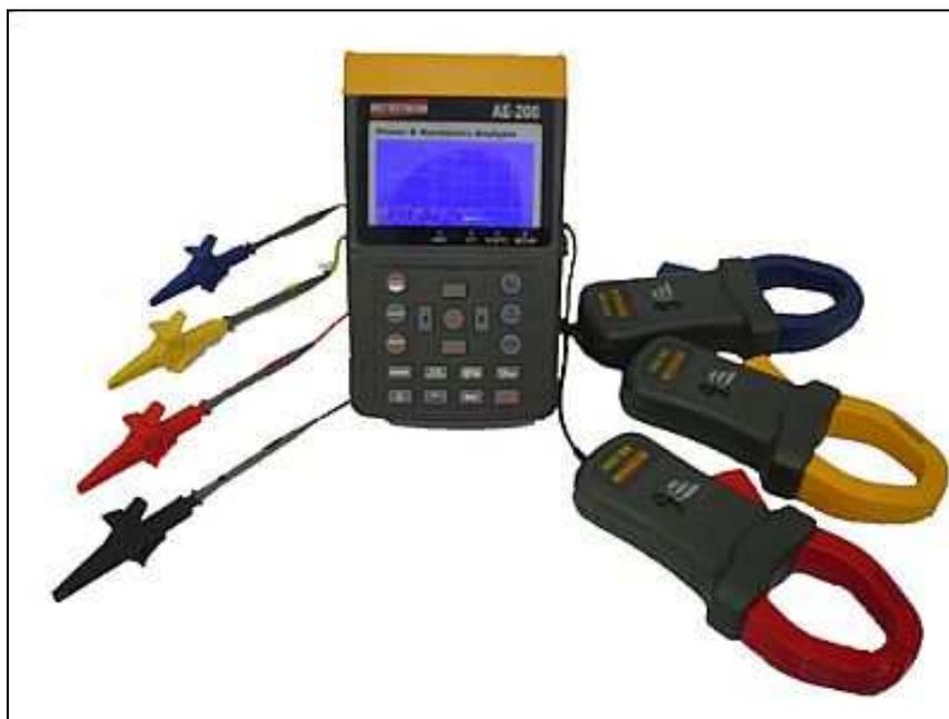
Figura 9 - Analisador de energia elétrica
