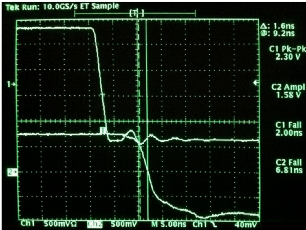
Figura 6.45: Medida de onda quadrada, com ênfase na borda de descida, demonstrando a capacidade de *slew-rate* do CFA básico. Forma de onda superior demonstra o sinal de entrada e a na inferior a de saída.
