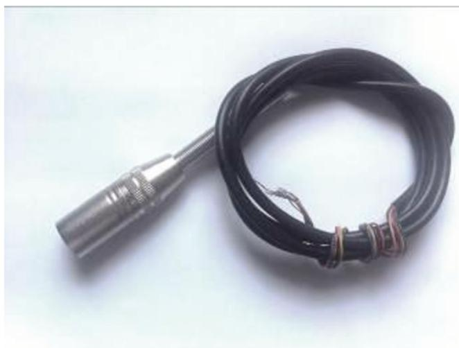
Figura 18 – Fotografia do sensor de vibração.
