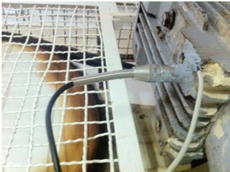
Figura 54 - Detalhe do sensor de vibração e temperatura instalados no redutor da lavadeira.
