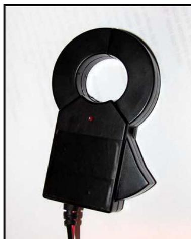
Figura 24 - Garra para medição de corrente.
