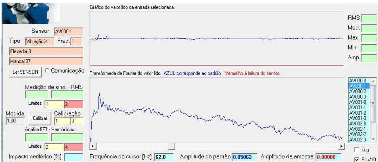
Figura 45 - Formato da onda para elevador carregando um HONDA FIT.
