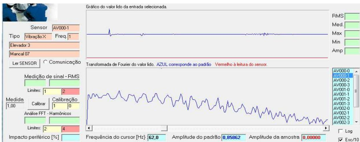
Figura 44 - Formato da onda para elevador carregando HONDA CIVIC.
