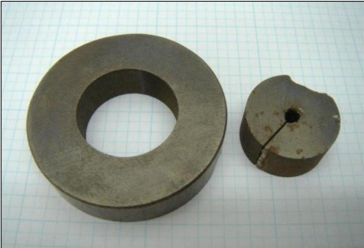
Figura 2.4 – Núcleo de Terfenol após o corte com eletro-erosão.
