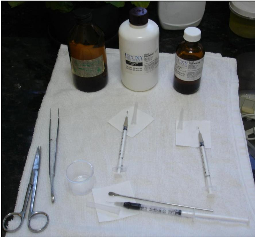
Figura 2.19 – Cola utilizada para a fixação da fibra. EPO-TEK 301
