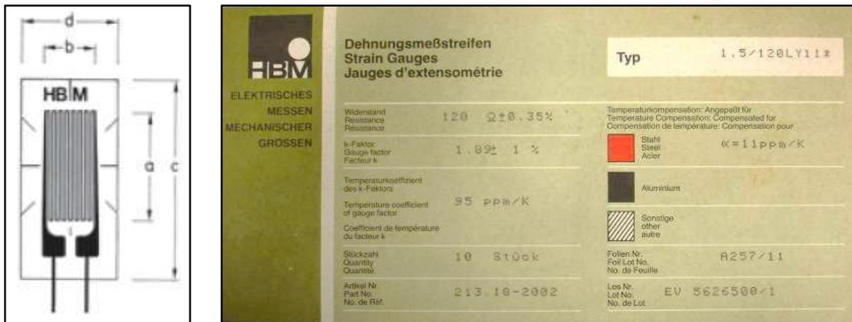
Figura 3.5 – Extensômetro de 120Ω do tipo LY11.
