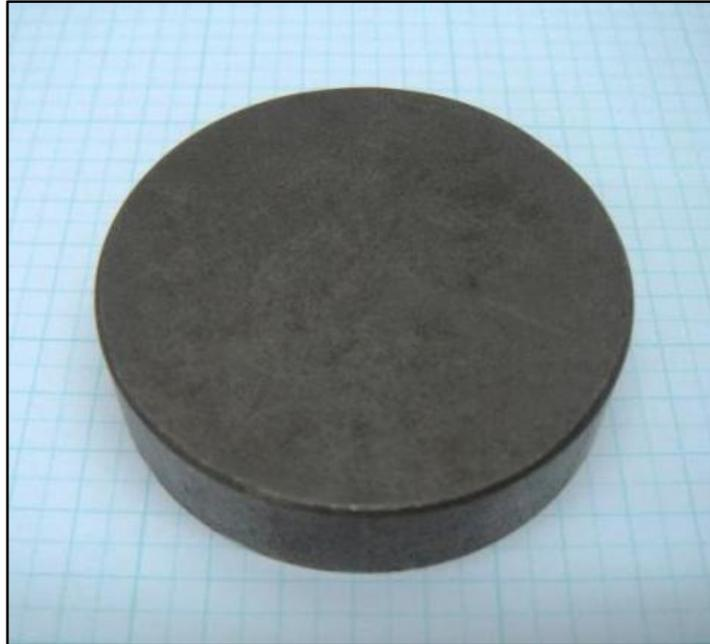
Figura 2.3 – Núcleo de Terfenol-D, diâmetro 40mm e altura de 20mm, antes do corte.
