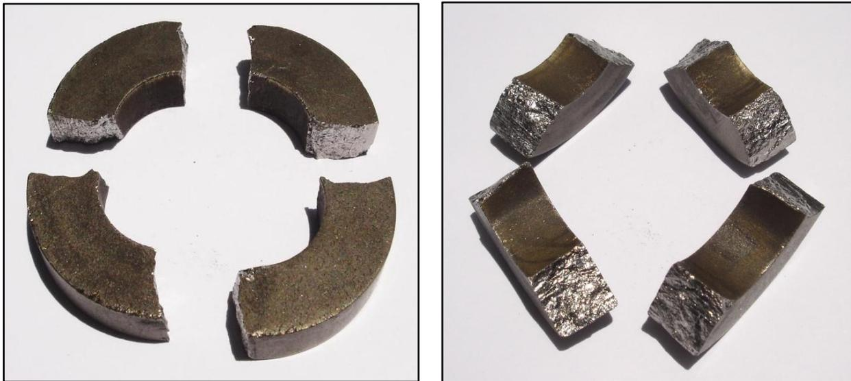
Figura 2.9 – Núcleo de Terfenol-D quebrado.
