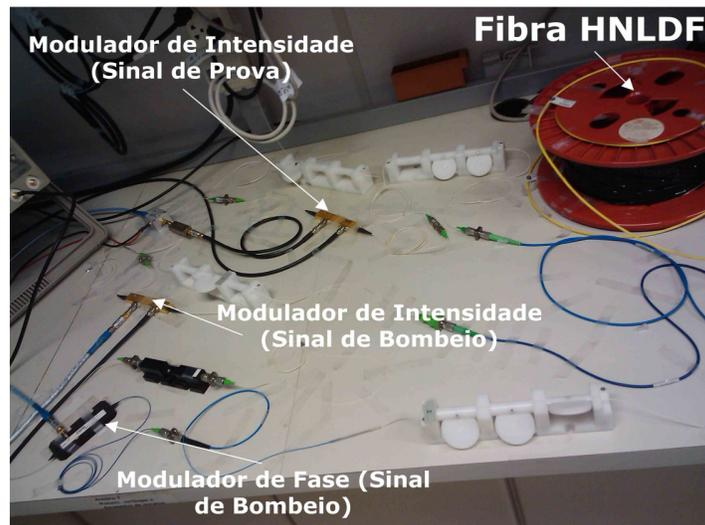
Figura 39 – Foto dos moduladores de amplitude e de fase, além da fibra HNL-DSF.
