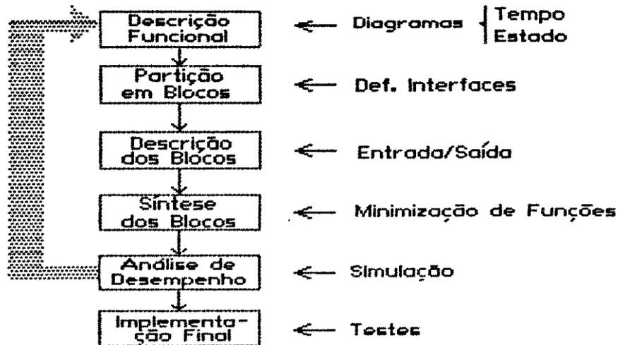
FIGURA I.1- Esquema de projeto de circuitos digitais.
