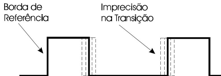
Figura 3.19 - Sinal de Sincronismo (*clock*) Apresentando Imprecisão nos Instantes de Transição (*jitter*).
