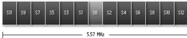
Figura 2.2 – Divisão do espectro OFDM de 13 segmentos do padrão ISDB-T<sub>B</sub>
