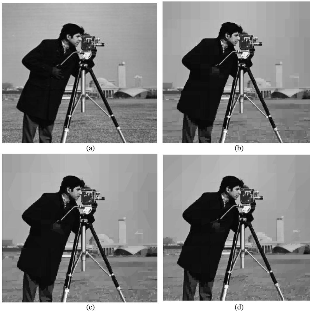
Figura 7.8 – Comparação subjetiva para a imagem ‘cameraman’ a 1 bpp (a) original (a) *wedgelet* de 2 ângulos e 4 distâncias (b) *wedgelet* de 8 ângulos e 4 distâncias (c) *wedgelet* de 8 ângulos e 1 distância.
