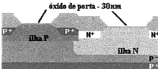
Figura 2.34 - Lâmina com o óxido de porta de 30 nm crescido na região ativa
