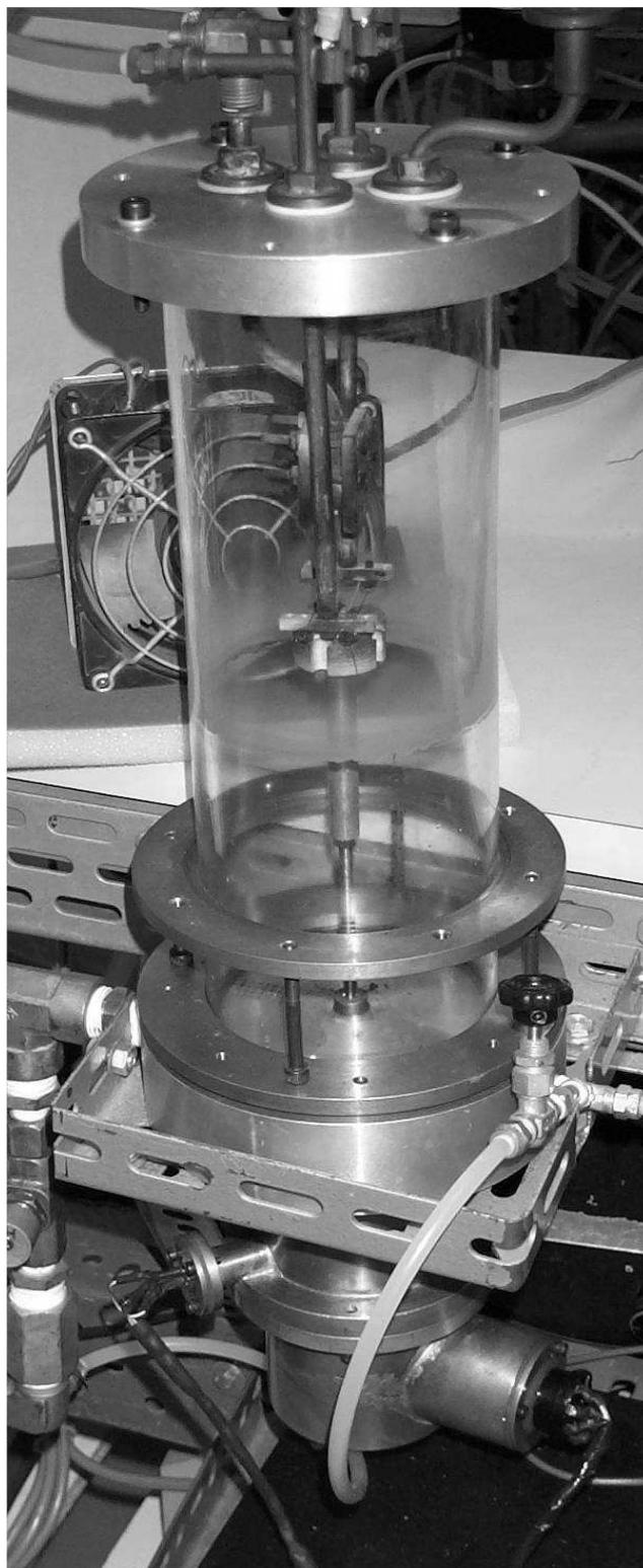
**Figura 2.13** Reator mostrando a desmontagem da flange superior.
