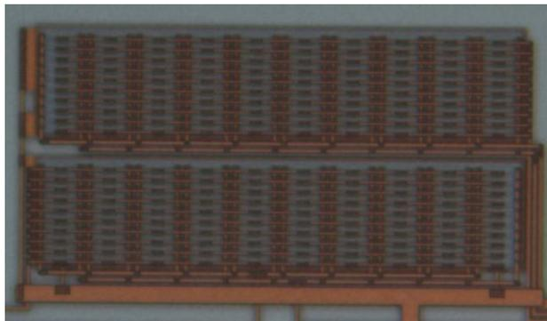
Figura A.2.5: Transistores NMOS para Teste de Corrente de Fuga.
