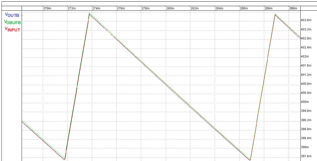
Figura 4.4.8: Saídas do filtro e seguidor do Filtro 2, com o padrão ECG (CENELEC) de alta amplitude aplicado à entrada, 0,9V  $V_{DD}$ .
