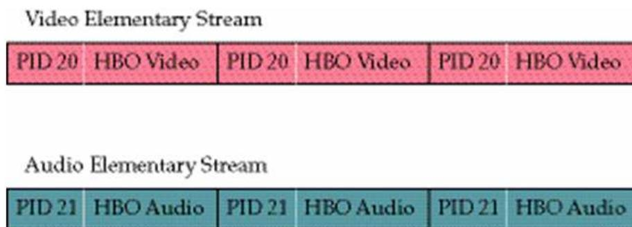
Figura 2.18 - PID no fluxo elementar.
