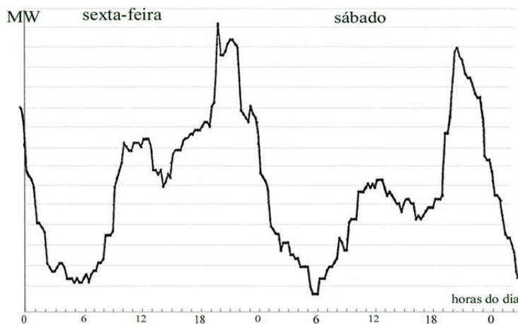
Figura 2.3: Curva de carga típica.
