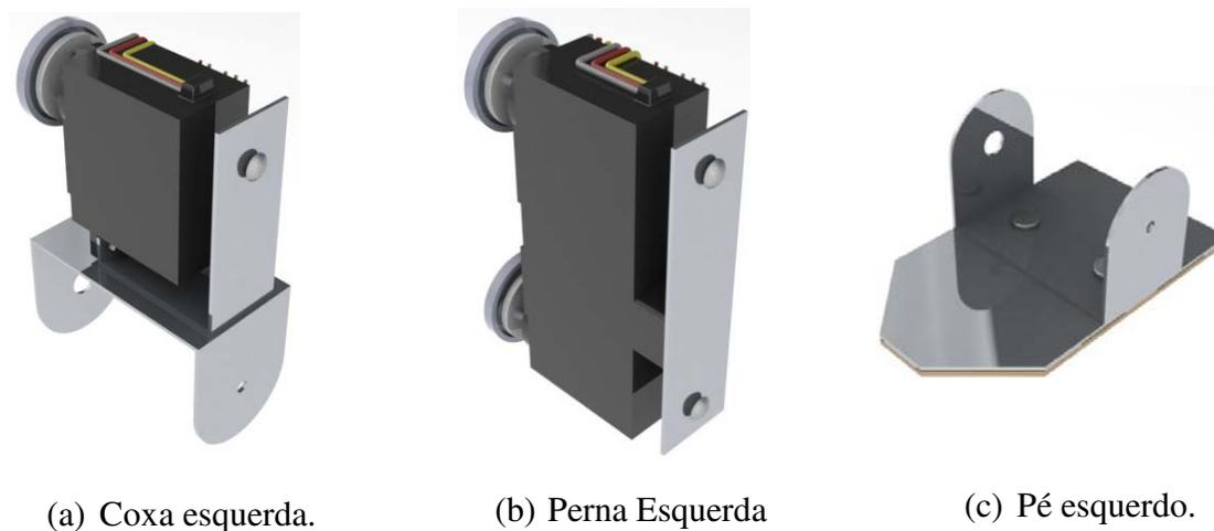
Figura 2.10: Componentes que compõem a perna esquerda do robô bíbepe desenvolvido
