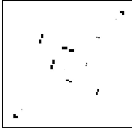
Figura 4.9 – Layout da fotomáscara para isolamento dos capacitores
