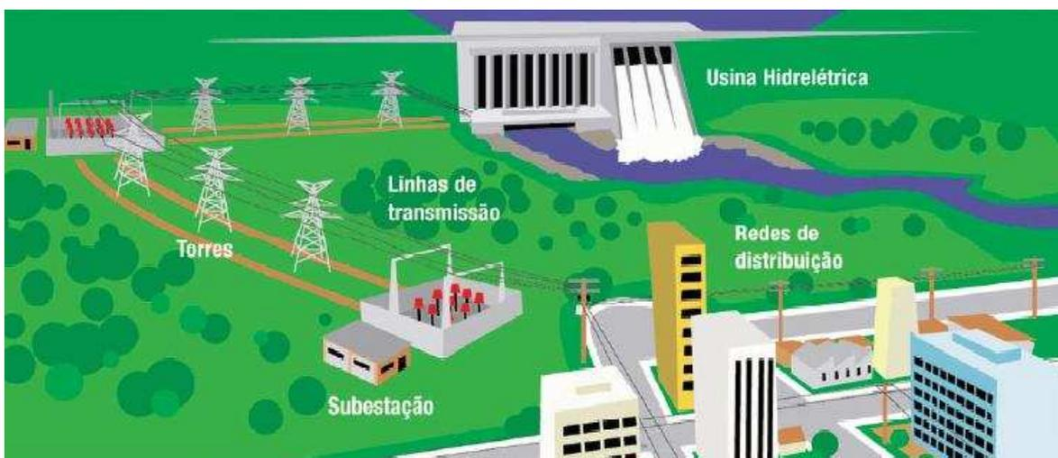
Fig. 2.4: Sistema Elétrico de Potência
