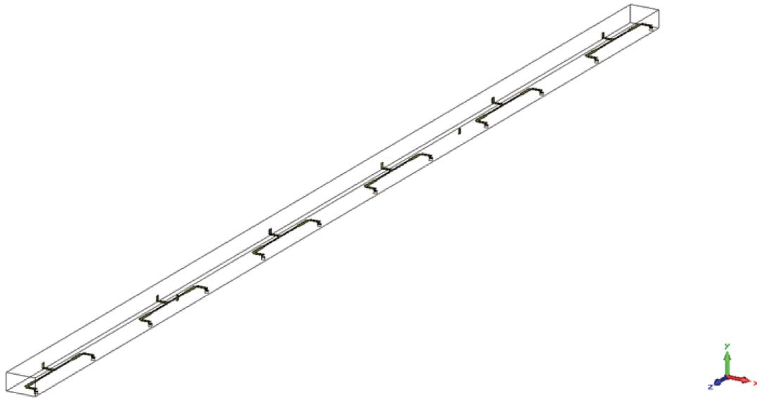
Figura VI-73: Nível 1 do Módulo C, formado por 6 divisores de potência.
