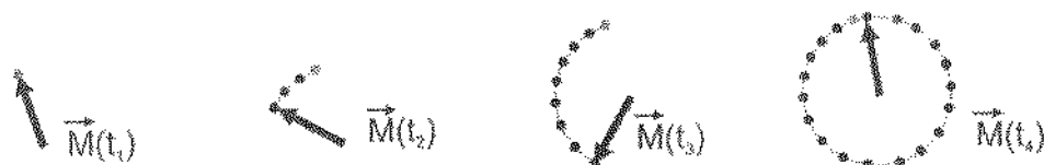
Figura 4.1 – Modelo teórico do VEM adotado para validação da montagem experimental e procedimento para determinação do vetograma. Neste modelo, VEM possui módulo constante e muda apenas sua orientação, que descreve uma circunferência.
