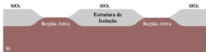
**Fig.1.6 – Corrosão do nitreto e óxido “almofada” para abertura das regiões ativas.**
