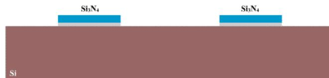
**Fig.1.4 – Ataque ao Si<sub>3</sub>N<sub>4</sub>/SiO<sub>2</sub> para formação das regiões ativas.**
