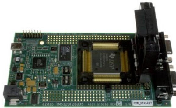
Figura 7.48: Placa eZdsp com o processador TMS320F28335 da Texas.
