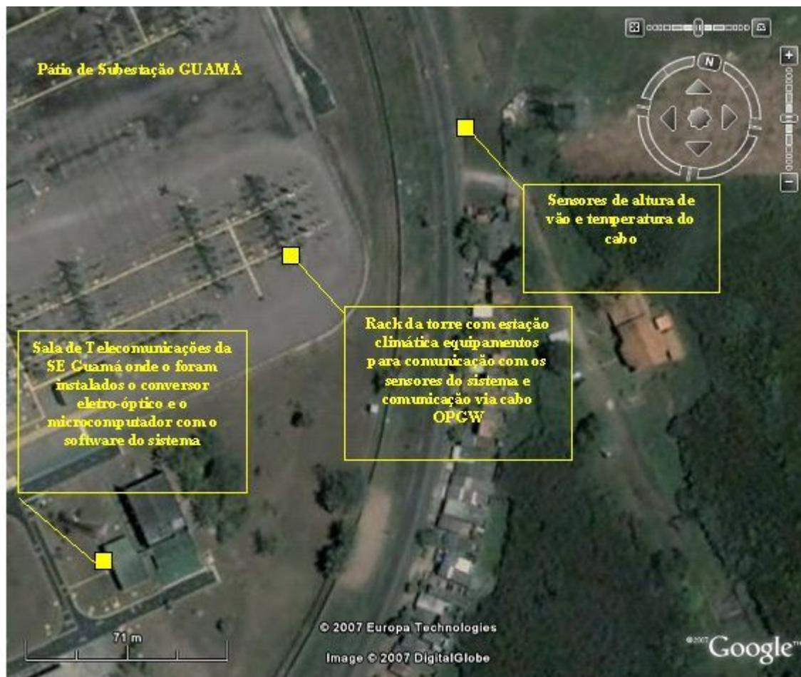
Figura 3.1: Posicionamento dos componentes do sistema.
