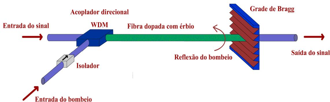
Fig. 3.4 – Configuração de um EDFA com sinal co-propagante e reflexão de bombeio.
