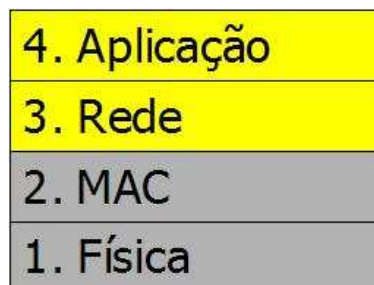
Fig. 3.2: Camadas do Protocolo ZigBee
