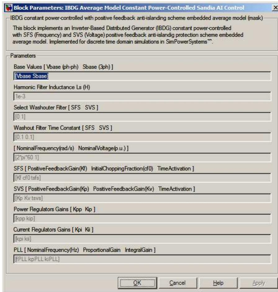
Figura B.3 – Máscara para definição dos parâmetros de simulação do IBDG injeção de potência constante com proteção antiilhamento por realimentação positiva da Sandia.
