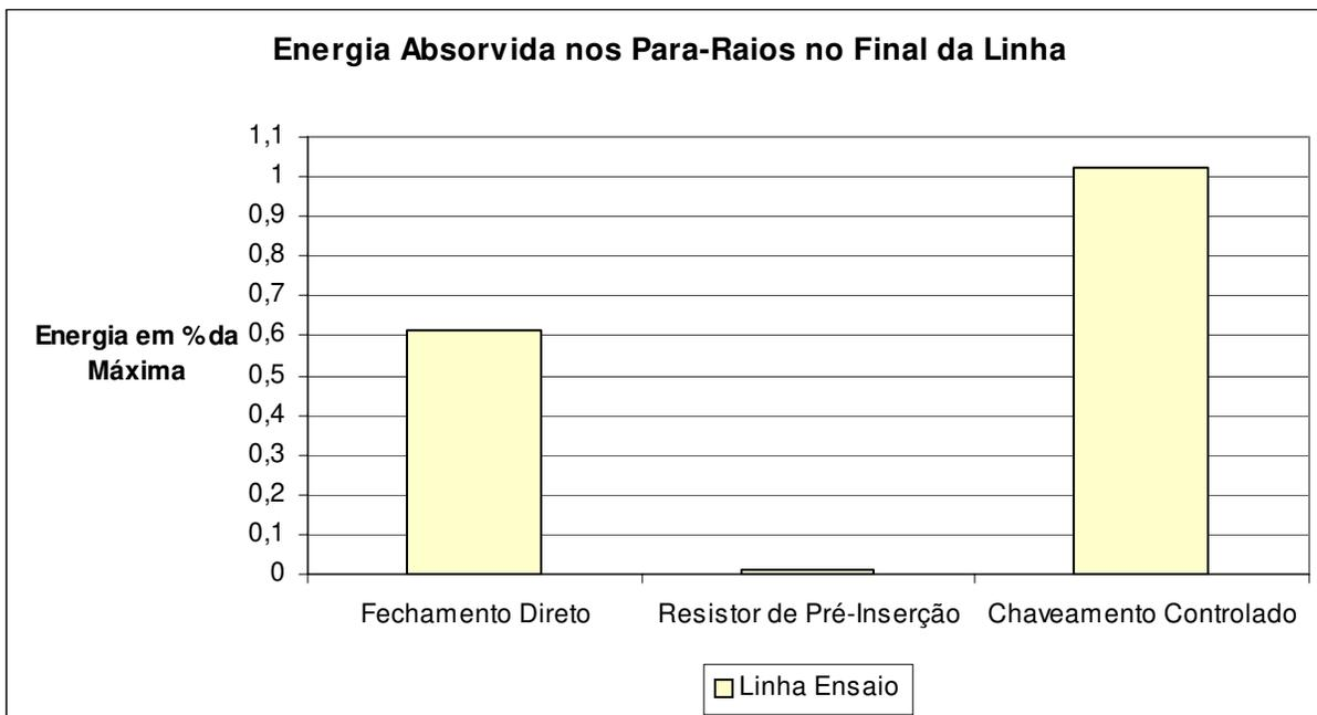
**Figura 5.14 – Energia absorvida pelos dispositivos pára-raios localizados no final da linha durante a energização da Linha I – Simulação com o ATP.**
