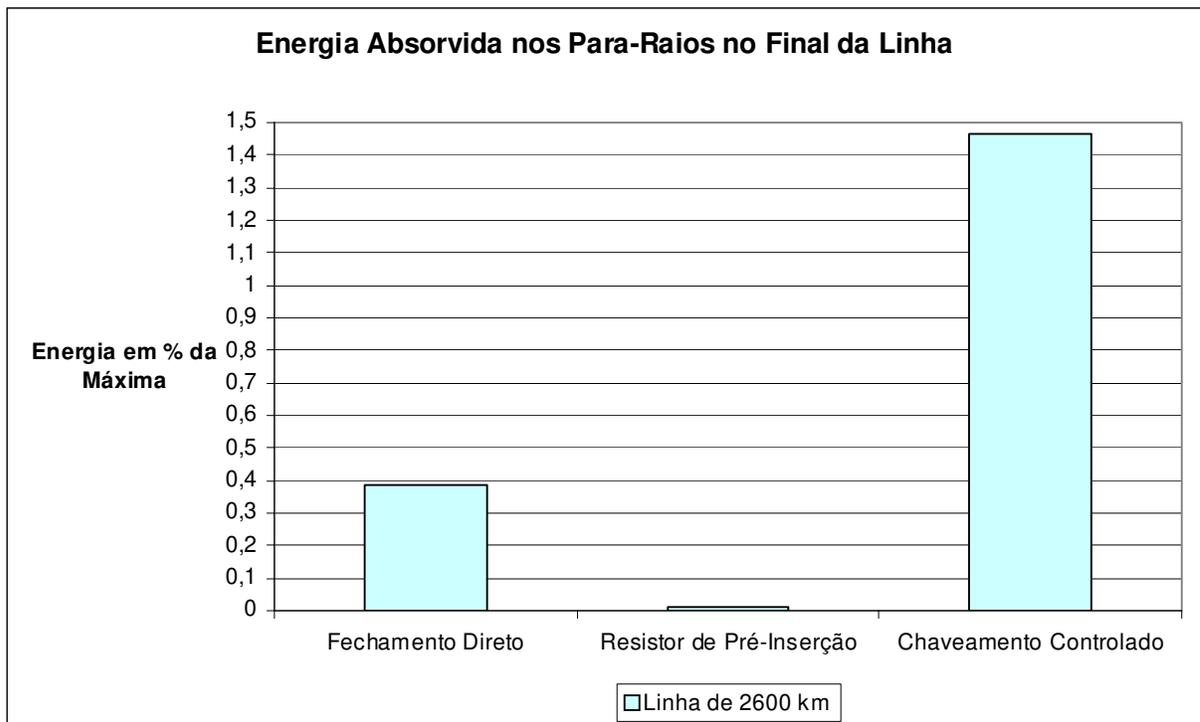
Figura 5.23 – Energia absorvida pelos dispositivos pára-raios localizados no terminal em vazio da linha durante a energização da Linha II – Simulação com o ATP.
