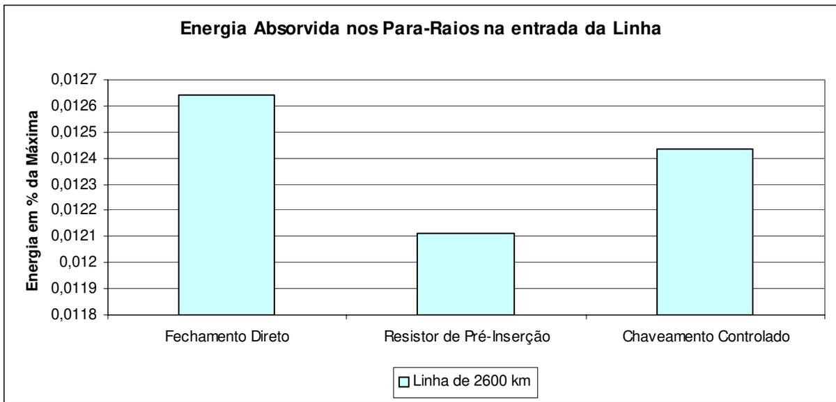
Figura 5.22 – Energia absorvida pelos dispositivos pára-raios localizados no início da linha durante a energização da Linha II – Simulação com o ATP.
