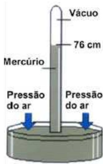
Figura 2.1: Experimento de Torricelli
