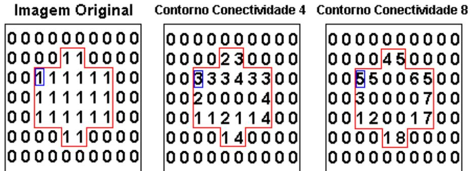
Fig. 4-13 - Retirando o Contorno de uma Imagem
